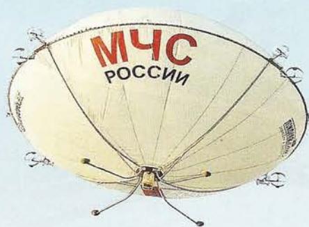
СУЩЕСТВУЮЩИЙ ЛОКОМОСКАЙНЕР диаметром 7 м может выполнять наблюдательные функции, например для МЧС
